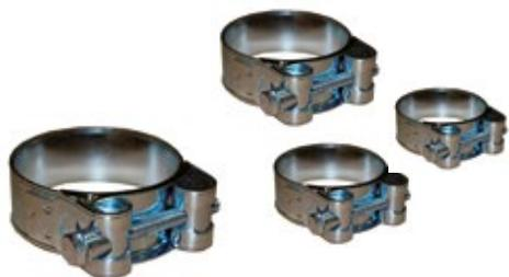
Fabricación conforme a la Norma DIN-3017, con bordes redondeados. Protección antioxidante (Zinc Bicromatado). Color acero blanco. Tres puntos de soldadura. Tornillos Norma ISO 8.8.
