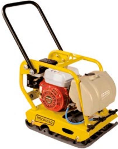
La motorización de este modelo incorpora de serie filtro de aspiración en baño de aceite. Grupo vibrante integrado en la plancha base, aumentando la capacidad de compactación y reduciendo los elementos sensibles de precisar mantenimiento. El equipo incluye de serie depósito de agua, elemento difusor y juego de ruedas para el transporte.
