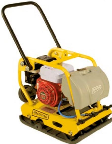
Potente motorización de 6,5 HP HONDA GX200 que aporta a este modelo una excelente capacidad de compactación. Dicho motor incorpora de serie filtro de aspiración en baño de aceite, garantizando una larga vida útil con unos bajos costes de mantenimiento. El equipo incluye de serie depósito de agua, elemento difusor y juego de ruedas para el transporte.
