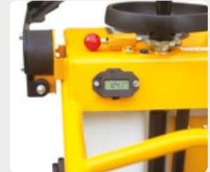
**Tacómetro cuenta-horas y r.p.m del motor**
