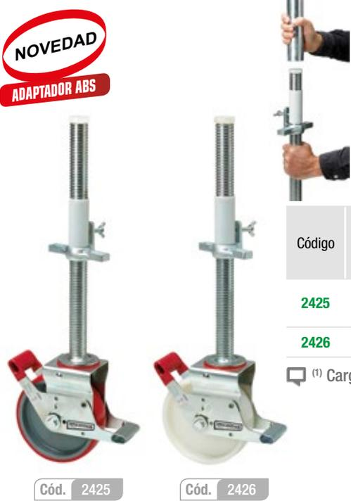
Sistema de doble freno que bloquea los desplazamientos horizontales y el eje de giro vertical. El bloqueo y desbloqueo del conjunto se realiza presionando sobre un pedal.
