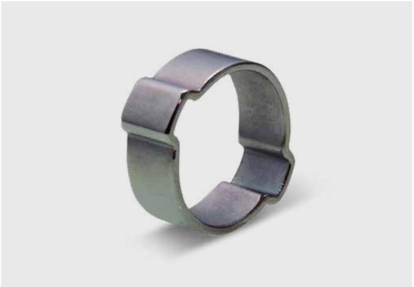
**Abrazadera sin tornillo de una sola pieza para bajas y medias presiones. El montaje es rápido, sencillo y seguro mediante el apriete de las orejas. La abrazadera se autoajusta en función de la dilatación o contracción de la manguera debido a cambios de temperatura.**
