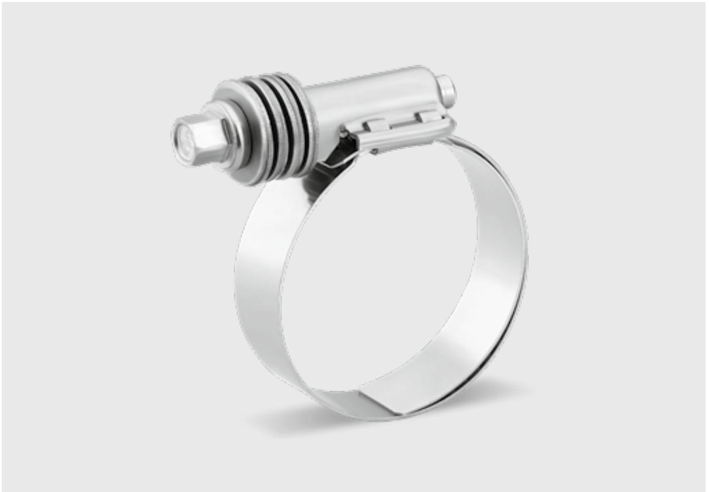
**Abrazadera Vis-Sin-Fin con muelle para aplicaciones pesadas y con fuertes oscilaciones de temperatura (refrigeración). El mecanismo de muelle Belleville patentado, permite que la abrazadera se ajuste automáticamente al diámetro del manguito cuando este se expande o contrae debido a cambios de temperatura extremos.**
