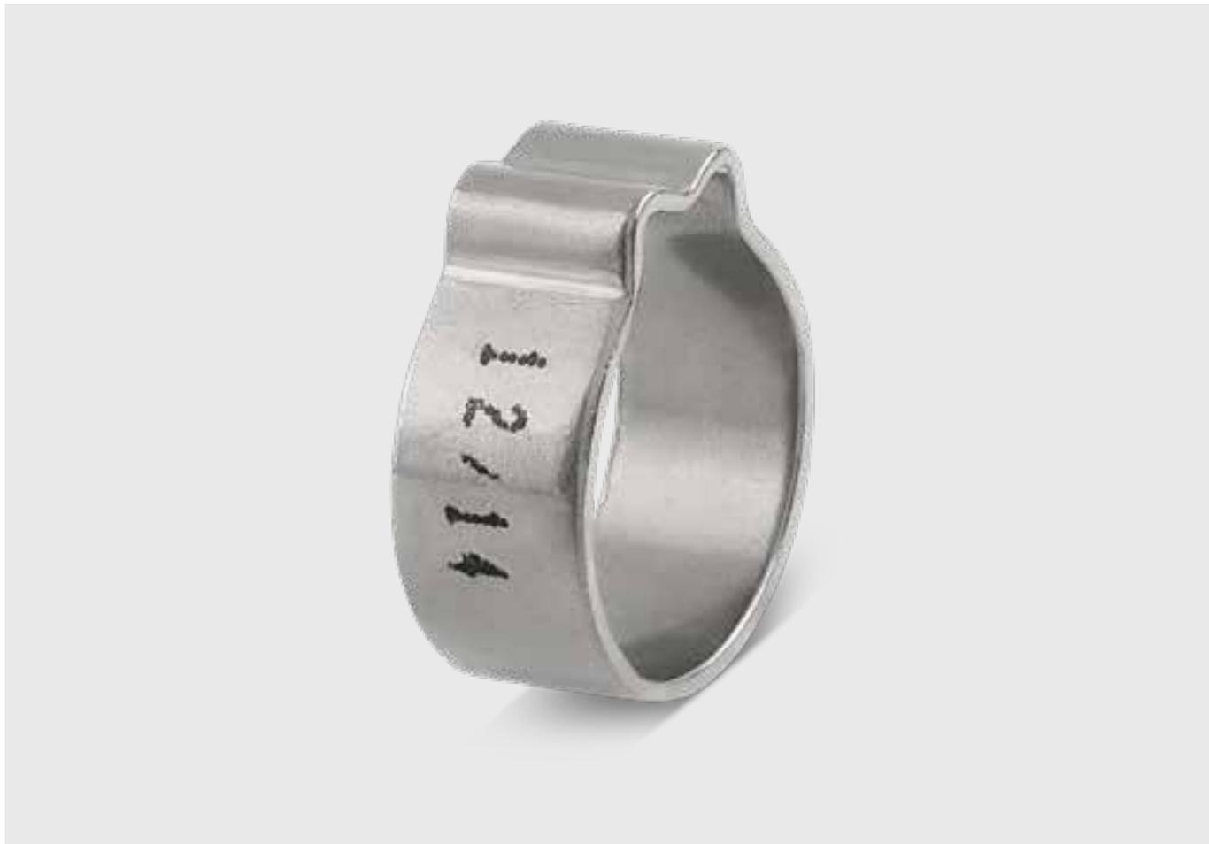
**Abrazadera sin tornillo de una sola pieza para bajas y medias presiones. El montaje es rápido, sencillo y seguro mediante el apriete de la oreja. La abrazadera se autoajusta en función de la dilatación o contracción de la manguera debido a cambios de temperatura. Ideal para instalaciones con una altura de montaje reducida.**
