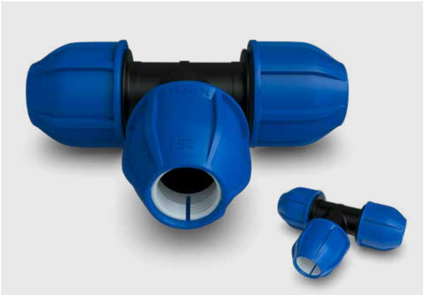
Los racores de compresión NORMA® se fabrican con polipropileno para tuberías de polietileno de alta y baja densidad, con diámetros de entre 20 y 110. Presión máxima de servicio: PN 10 bar en diámetro 16 – PN 16 bar en diámetros entre 20 y 63 – PN 12,5 bar en diámetros entre 75 y 110.
