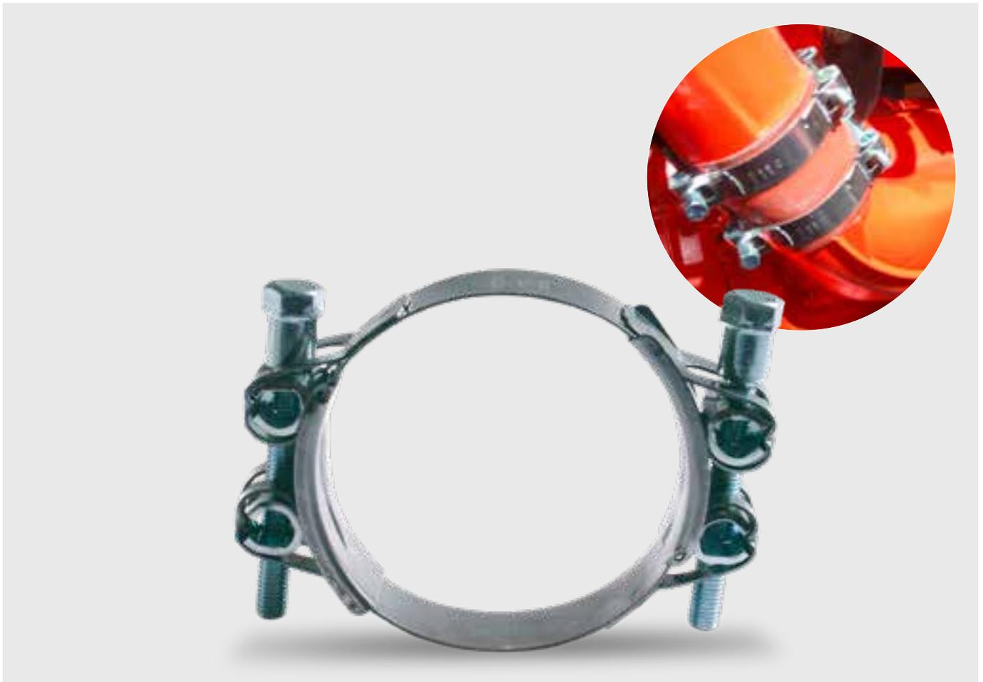
El doble cierre de la GBS permite el montaje de la abrazadera en espacios de difícil acceso, una mayor tolerancia por referencia, y montar la abrazadera con el tubo ya insertado.
