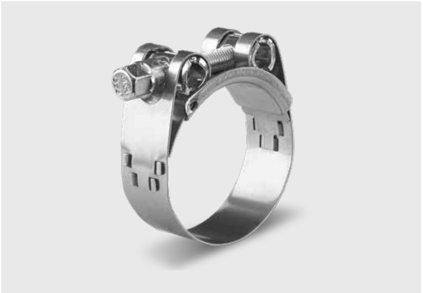
**Abrazadera de gran presión con un exclusivo sistema de enganche mecánico que proporciona una máxima robustez y una alta tensión de fleje. La presillas reforzadas permiten absorber unas fuerzas de apriete y pares de rotura muy elevados. Fabricada según el DIN 3017.**
