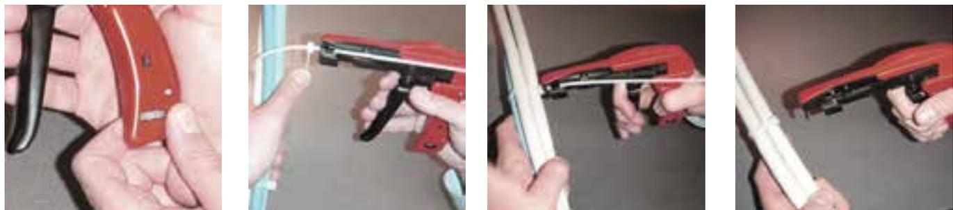
Instalación de la brida "Bellring Plus" con herramienta de corte manual
