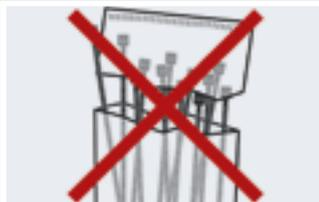
Tras la apertura de la bolsa, utilizar las bridas y cerrar la bolsa con el contenido restante, para preservar la correcta humedad de las bridas.
